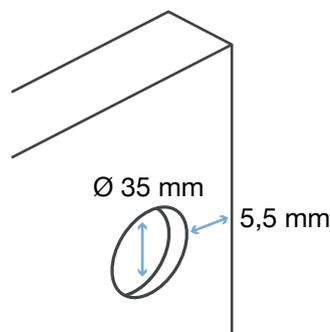
Die Topfbandbohrungen werden standardmäßig 5,5 mm eingerückt und haben einen Durchmesser von 35 mm. Wenn du andere Maße für die Topfbandbohrung wünschst, kannst du diese im Konfigurator angeben.
